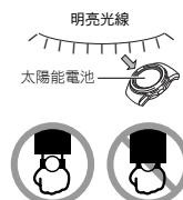
本錶內置的充電電池會儲存由太陽能電池產生的電能。在照射不到光線的地方放置或使用本錶會使電池的電量耗盡。請盡可能地讓手錶照射到光線。
