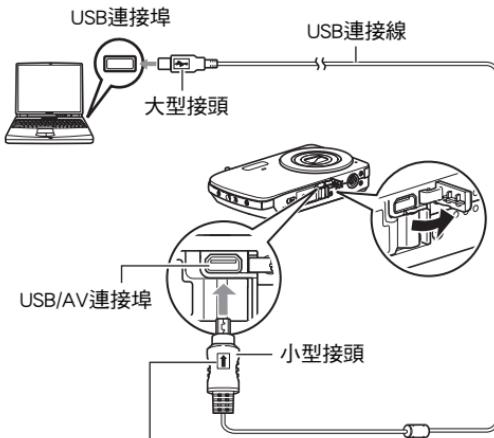
確認USB連接線接頭上的↑標記朝向鏡頭那一面，然後將連接線連接到相機上。
