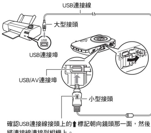
確認USB連接線接頭上的↑標記朝向鏡頭那一面，然後將連接線連接到相機上。
