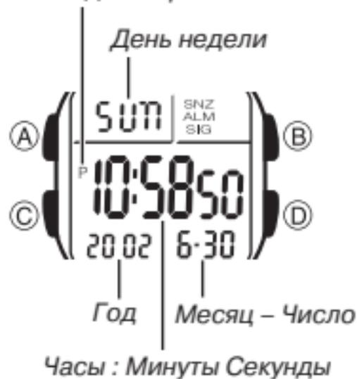
3. В то время, когда цифры в разряде секунд будут находиться в мигающем состоянии, нажмите кнопку "D", для сброса счетчика секунд в "00". Если кнопка "D" нажата в то время, когда значение секунд будет находиться в диапазоне от "30" до "59", то одновременно с переустановкой секунд в положение "00", к значению минут будет добавлена "1". Если значение секунд в этот момент будет находиться в диапазоне от "00" до "29", то значение минут останется без изменений.
