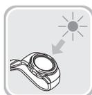
Quando si indossa l'orologio, assicurarsi che il quadrante (pannello solare) non sia coperto dalla luce dalla manica dei vestiti. L'efficienza di generazione dell'energia è ridotta anche quando il quadrante dell'orologio è coperto solo parzialmente.
