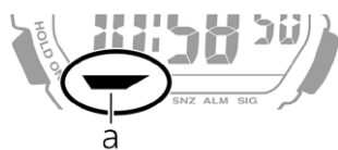
a. Indicateur de contrôle
