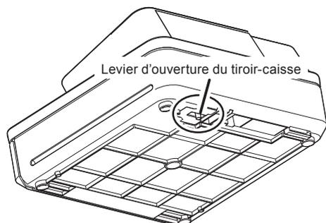
En cas de panne de courant ou de dysfonctionnement de la machine, le tiroir-caisse ne s'ouvre pas automatiquement. Dans ces situations, vous pouvez ouvrir le tiroir-caisse en tirant le levier d'ouverture du tiroir-caisse (voir ci-dessous).
