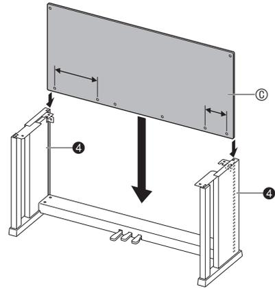
4. Sichern Sie mit den beiden Schrauben ⑥ die Rücktafel ③ an den oberen linken und rechten Kanten in den Haltern ⑤ der Seitentafeln ① und ②.
