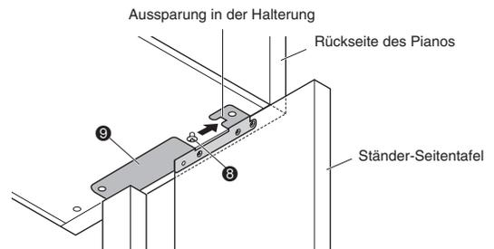
8. Sichern Sie als Erstes mit den beiden Schrauben ① die Rückseite des Pianos am Ständer (auf der linken und rechten Seite). Sichern Sie dann mit den beiden Schrauben ② die Vorderseite des Pianos am Ständer (auf der linken und rechten Seite).
