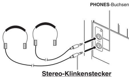
Schließen Sie einen im Fachhandel erhältlichen Kopfhörer an die **PHONES**-Buchsen an. Durch Anschließen eines Kopfhörers an eine der **PHONES**-Buchsen wird die Wiedergabe über die Lautsprecher abgeschaltet, wodurch auch spät nachts geübt werden kann, ohne damit andere zu stören. Zum Schutz des eigenen Gehörs ist bei der Benutzung eines Kopfhörers darauf zu achten, dass die Lautstärke nicht zu hoch eingestellt ist.
