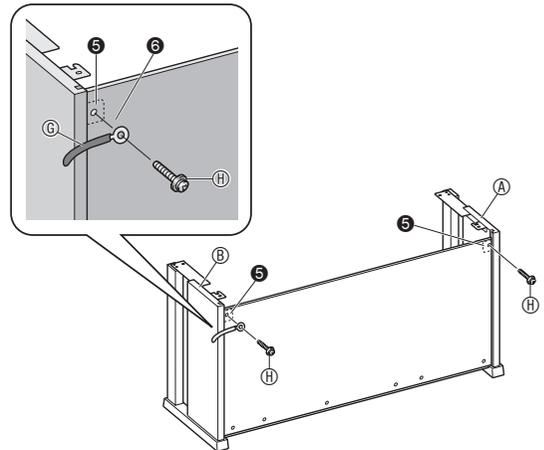
5. Sichern Sie als Nächstes den Boden der Rücktafel ③ mit den sechs Schrauben ⑥.
