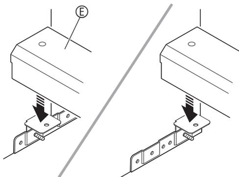
7. Befestigen Sie die Halter  $\textcircled{L}$  an den beiden Enden der Pedaleinheit  $\textcircled{E}$ .
