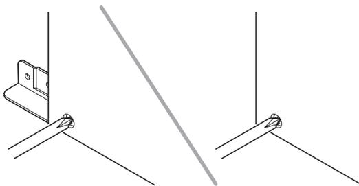
10. Sichern Sie die Rückplatte  $\textcircled{K}$  an der Rückplatte  $\textcircled{C}$ .
