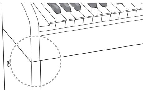
13. Befestigen Sie mit Schrauben ④ die oben an den Seitentafeln ② und ③ befindlichen Halter am Boden des Pianos.
