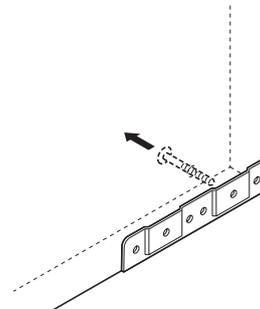
4. Setzen Sie die Stützwinkel  $\textcircled{H}$  in den Spalt zwischen Kippschutzlasche und Seitentafel ein.
