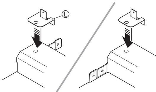
8. Sichern Sie mit den Schrauben  $\textcircled{F}$  die Halter  $\textcircled{L}$  an der Pedaleinheit  $\textcircled{E}$ .
