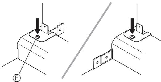
9. Ziehen Sie nach dem Einstellen der Position (Höhe) von Pedaleinheit  $\textcircled{E}$  die im obigen Schritt 5 provisorisch angezogenen Schrauben fest.
