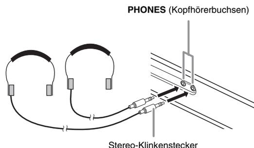
Durch Anschließen eines Kopfhörers an eine der **PHONES**-Buchsen wird die Wiedergabe über die Lautsprecher abgeschaltet, wodurch auch spät nachts geübt werden kann, ohne damit andere zu stören. Zum Schutz des eigenen Gehörs ist bei der Benutzung eines Kopfhörers darauf zu achten, dass die Lautstärke nicht zu hoch eingestellt ist.
