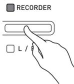
2. Wählen Sie bei gedrückt gehaltener **FUNCTION**-Taste mit der **RECORDER (L/R)**-Taste die beim Aufnehmen wiederzugebende Spur.
