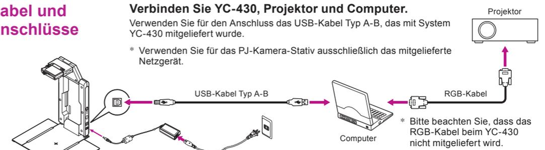
Näheres finden Sie unter „Einrichtung des Multi-PJ-Kamerasystems“ in der Bedienungsanleitung des YC-430.
