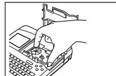
3. Mit einem dünnen, spitzen Gegenstand wie in der Abbildung gezeigt die gelbe Schneideinheit aus dem Etikettendrucker herausheben.
