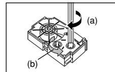
5. Die Etikettenband-Kassette in den Etikettendrucker einlegen; stellen Sie dabei sicher, daß das Etikettenband und das Farbband zwischen Kopf und Walze hindurchgehen.
