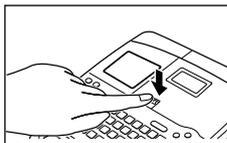
3. Die Halteklemme von einem neuen Etikettenband entfernen und überprüfen, daß das Etikettenband bereit zur Verwendung ist.
