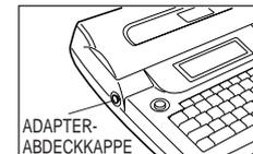
Setzen Sie die Adapter-Abdeckkappe in den Halter an der Innenseite der Abdeckung ein, um zu verhindern, dass die Abdeckkappe verloren geht. Die Entriegelung der Abdeckung drücken, dann die Abdeckung öffnen.
