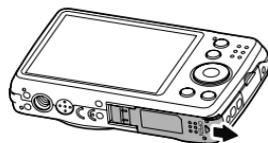
2. Entriegeln und öffnen Sie das Akku/Speicherkartenfach am Boden der Kamera.
