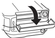
2. Die Auswurf-taste drücken, so dass diese an der Kamera hervorsticht.
