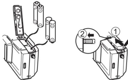
Die Batterien so einsetzen, dass ihre positiven (+) und negativen (-) Enden in die in der Abbildung gezeigten Richtungen weisen.
