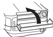
Entfernen einer Speicherkarte aus der Kamera
