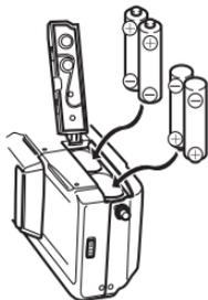
4. Den Batteriefachdeckel (①) schließen und danach die Verriegelung des Batteriefachdeckels gegen die Rückseite der Kamera schieben, um den Deckel zu verriegeln (②).
