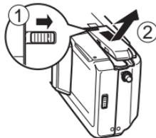
An der Unterseite der Kamera die Verriegelung des Batteriefachdeckels gegen die Frontseite der Kamera schieben (①), um den Deckel freizugeben.
