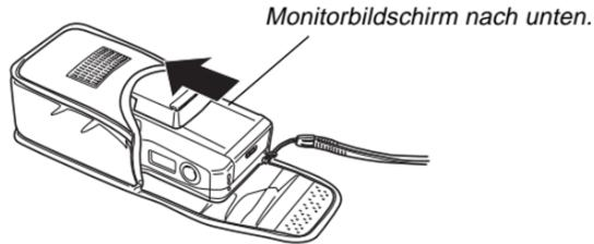
*Falls Sie den Gurt durch die Öffnung an der Seite der Tragetasche führen, können Sie die Kamera verwenden, ohne diese aus der Tragetasche zu entfernen.*
