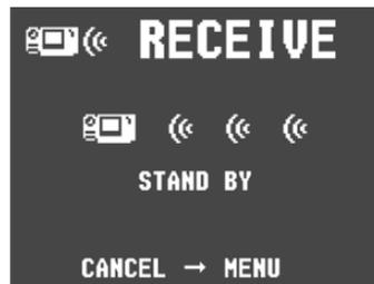
3. Das Infrarot-Port der Kamera mit dem Infrarot-Port der Sendeeinheit ausrichten und mit der Sendeoperation beginnen.
