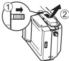
2. Beide Seiten des Batteriefachdeckels erfassen und diesen aufschwingen (②).
